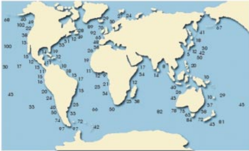
Figura 1.1 Distribuição do potencial mundial das ondas em kW/m de frente de onda
