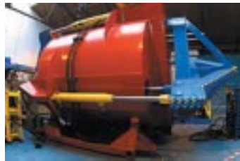
Figuras 3.4.9 e 3.4.10 Detalhe e vista lateral do módulo de conversão de energia do Pelamis (cortesia OPD Ltd)
