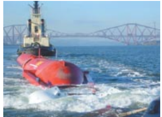
Figura 3.4.13 Lançamento do primeiro Pelamis à escala 1:1 (cortesia OPD Ltd)
